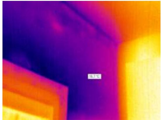
Mise en évidence d'une différence importante de température (intérieur/extérieur) sur un mur donnant sur l'extérieur
