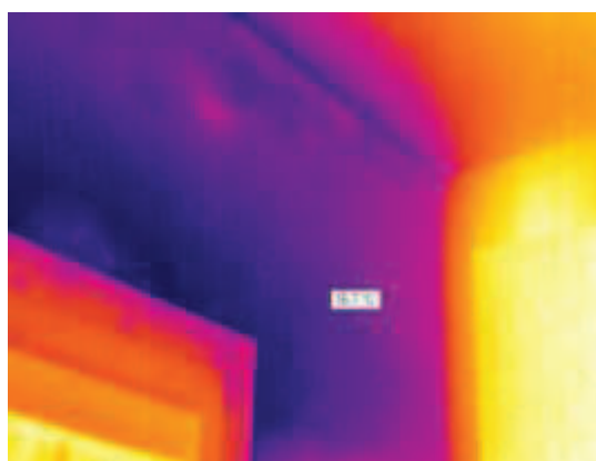
Mise en évidence d'une différence importante de température (intérieur/extérieur) sur un mur donnant sur l'extérieur
