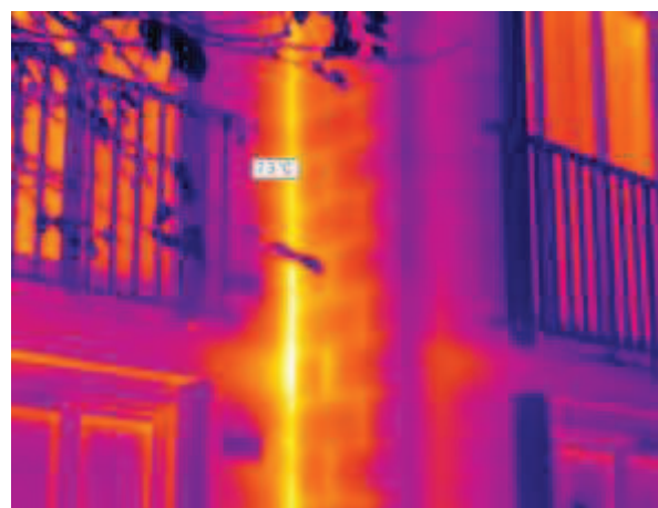
Mise en évidence d'un pont thermique au niveau du mur de refend
