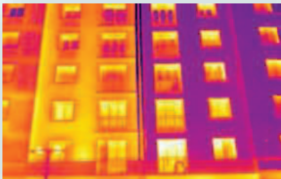
Mur extérieur non isolé Déperditions de chaleur Jaune = chaud de l'intérieur qui sort à l'extérieur
