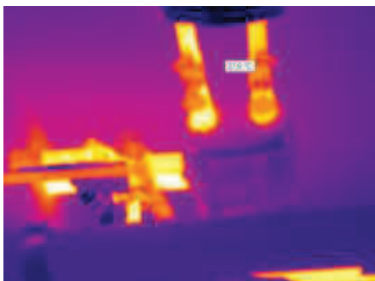
Différence de température entre la tuyauterie isolée et non isolée
