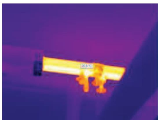
Différence de température entre la tuyauterie isolée et non isolée
